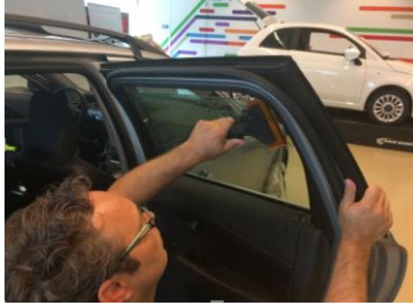
Coloque el film en la parte interior de la ventanilla y alinee con el borde superior. Asegúrese de que el cristal interior y la cara del adhesivo estén lo suficientemente húmedos para permitir la movilidad y el fácil posicionamiento del film. Tenga cuidado durante esta fase de evitar la formación de arrugas en la superficie del film.
