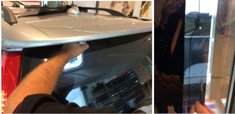
Después, prepare la parte interior de la luna trasera limpiándola y humedeciéndola con agua jabonosa para poder colocar el film. Al humedecer la parte interior del cristal, asegúrese de proteger el interior del vehículo.
