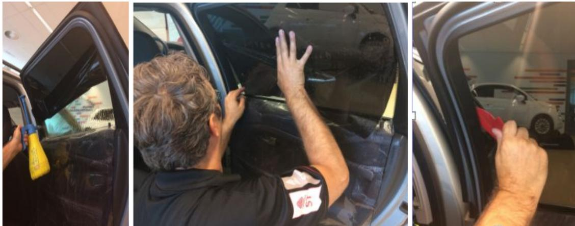
Cuando el film esté colocado, vuelva a humedecer la superficie del film y aplique presión uniforme con la espátula para activar el adhesivo y fijar el film, retirando todo el exceso de agua del lado del adhesivo.
